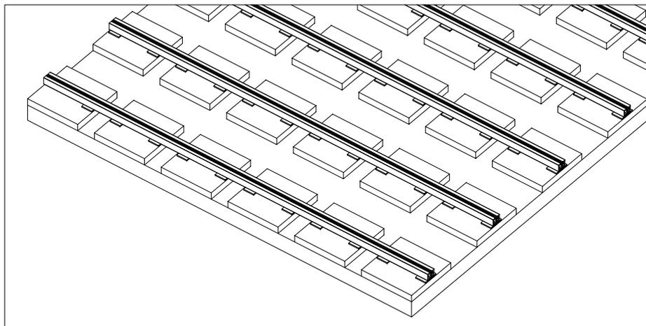
Для укладки на тротуарную плитку необходимо использовать лагу ДПК 50X40 или лаги из профильной металлической трубы min 60X40X3мм.
