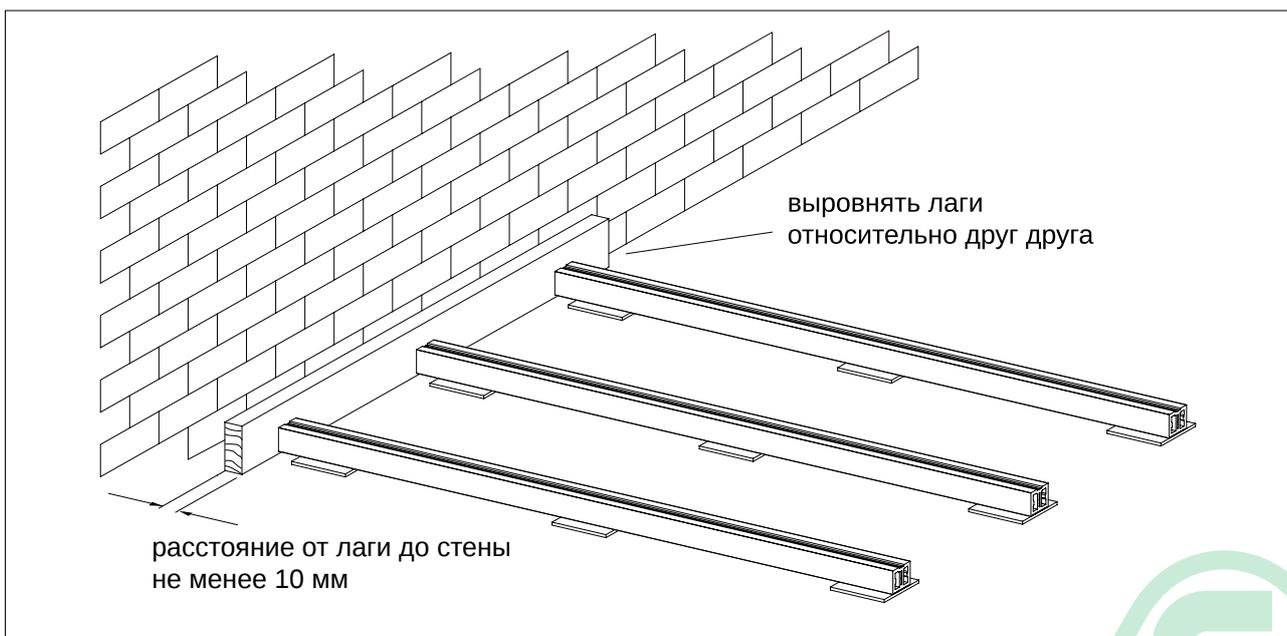
Лаги устанавливаются с максимальным шагом 400 мм, параллельно друг другу и под углом 90 градусов относительно направления укладки доски.
