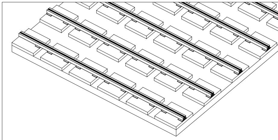
Для укладки на тротуарную плитку необходимо использовать лагу ДПК 50Х40 или лаги из профильной металлической трубы min 60Х40Х3мм.
