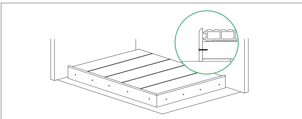
Вариант 3. Торцы настила закрываются при помощи F-профиля
