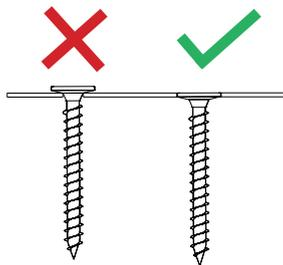
Не прилагайте излишнее усилия при вкручивании самореза в лагу во избежание прокручивания самореза.
