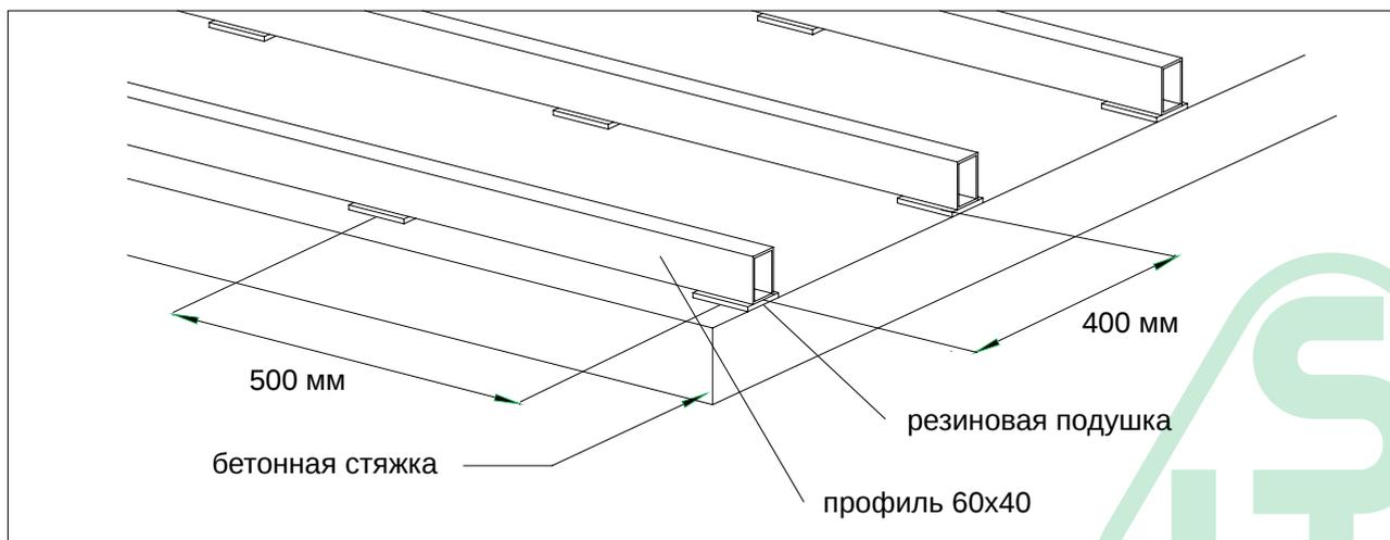
5.3 Для строительства настилов так же возможно устройство основания на винтовых сваях с последующей обвязкой и изготовлением сварного металлокаркаса. В качестве лаг используется профильная труба 60X40X3мм или лага ДПК 50X40. Основание на винтовых сваях обладает высокой несущей способностью и позволяет создавать сложные конструкции из металлокаркаса
