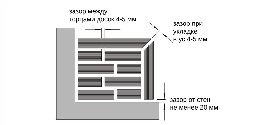
Необходимо учитывать, что при монтаже на открытых пространствах при плюсовой температуре окружающей среды в дневное время и отрицательной в ночное, компенсационные зазоры будут меняться.
