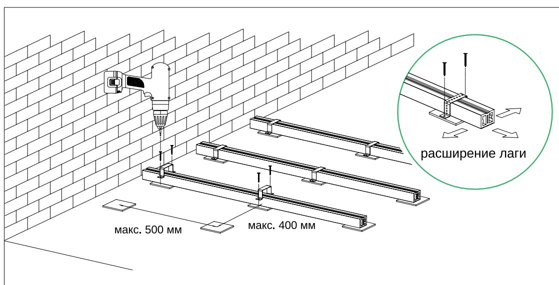
Для бетонного основания допускается монтаж лаг ДПК 50Х40, лаги ДПК 33Х48, а также лаги из профильной металлической трубы минимального размера 60х40х3мм.
