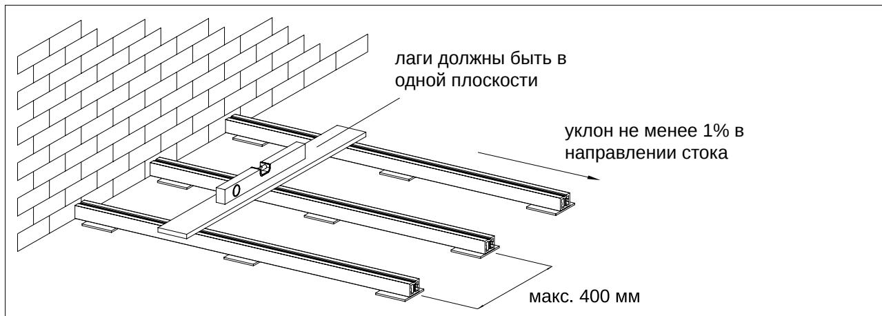
Лаги ДПК, при необходимости их продолжения, укладываются внахлест друг за друга на 150 мм и крепятся перфорированной металлической лентой.
