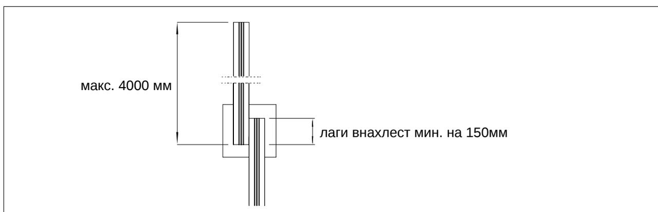
При стыковке досок в настиле на каждый конец доски предусмотрите одну опорную лагу на каждый конец доски, свес доски с лаги должен быть не более 50 мм.
