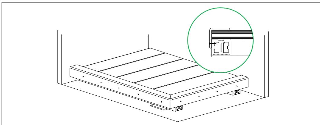
Вариант 2. Торцы настила закрываются при помощи торцевой рейки. Торцевая рейка крепится к лаге на саморезы с шагом не более 300 мм в предварительно просверленное отверстие на 2 мм большее, чем диаметр самореза.
