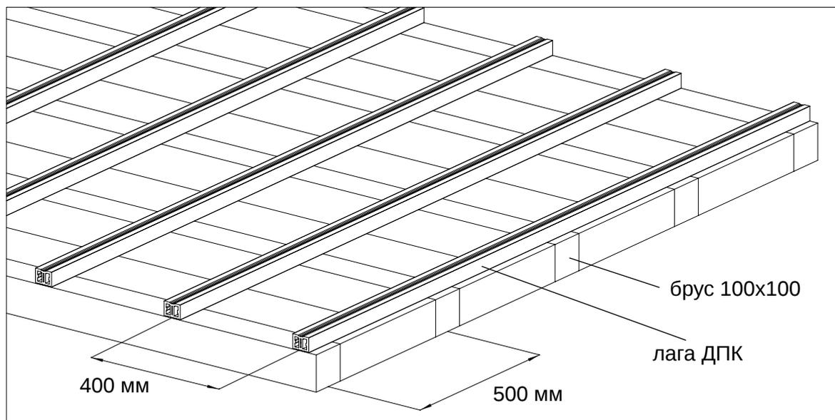
Допускается монтаж лаг на металлический каркас с сечением профиля 60x40x3 мм с шагом 500 мм при использовании лаги ДПК 50x40 и с шагом 1200 мм при использовании лаги из металлической профильной трубы 60x40x3.
