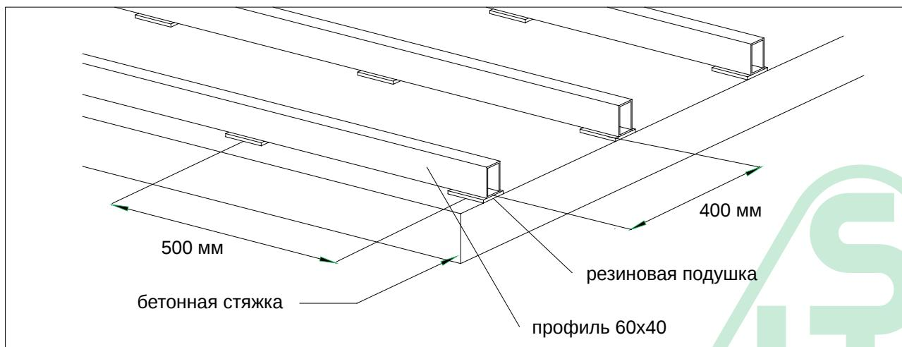
5.3 Для строительства настилов так же возможно устройство основания на винтовых сваях с последующей обвязкой и изготовлением сварного металлокаркаса. В качестве лаг используется профильная труба 60Х40Х3мм или лага ДПК 50Х40. Основание на винтовых сваях обладает высокой несущей способностью и позволяет создавать сложные конструкции из металлокаркаса
