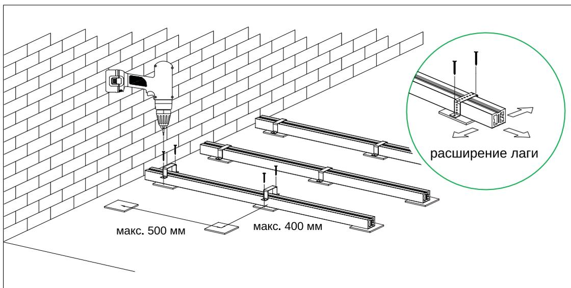
Для бетонного основания допускается монтаж лаг ДПК 50X40, лаги ДПК 33X48, а также лаги из профильной металлической трубы минимального размера 60x40x3мм.
