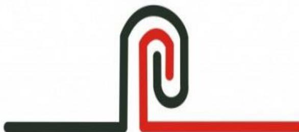
Такого рода соединение не пропускает влагу даже при отсутствии герметика, что позволяет сэкономить деньги во время установки отлива.
